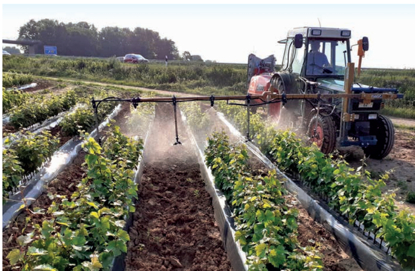
Abb.1: Spritzgestänge mit verstellbaren Düsenhalterungen für Rebschulen mit normalen, kleinen Reben
