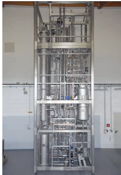
Abb.: Pilotanlage der Firma Montz zur Entalkoholisierung kleiner Volumina von Weiß- und Rotwein
