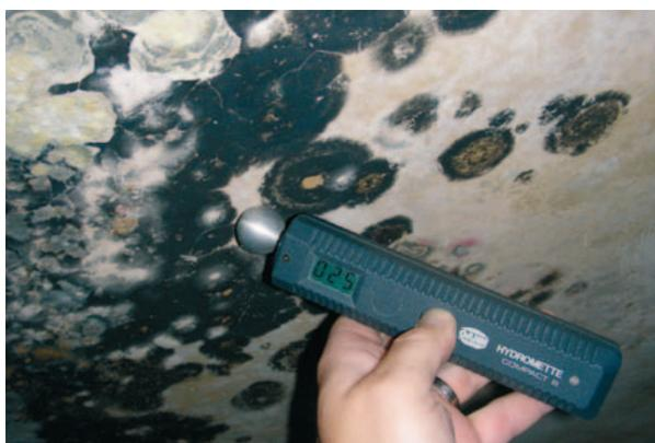
Bild 1 und 2: Typische Schimmelschäden
