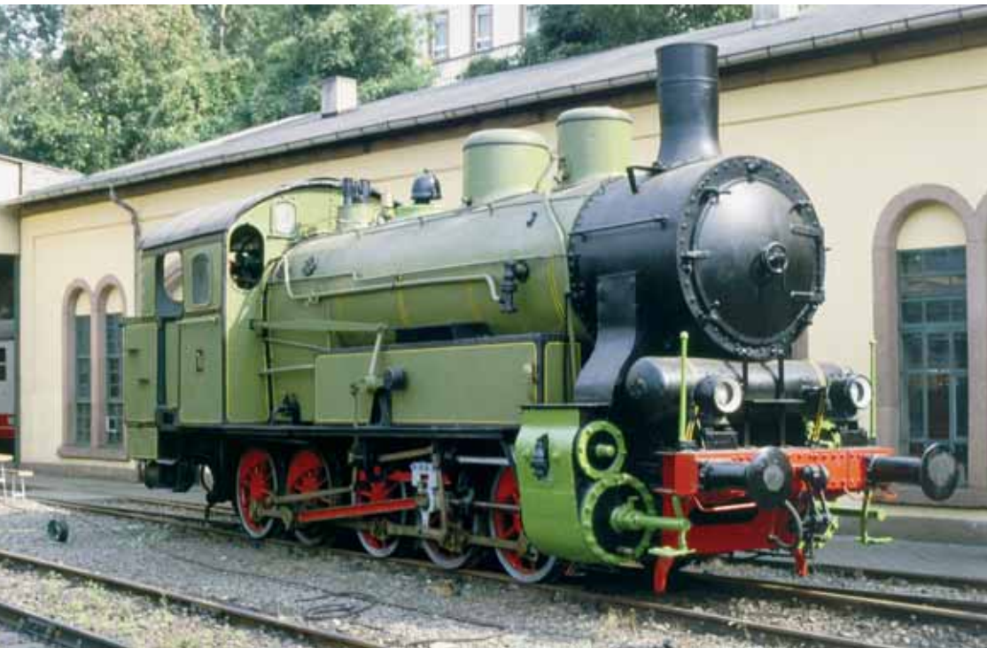
Die vier schweren Tenderloks der Baureihe T 5 wurden im Jahr 1907 speziell für die Steilrampe nach Pirmasens beschafft. Das letzte erhaltene Exemplar mit der Pfälzbahn-Lok-Nummer 307 steht ebenfalls bei der DGEG in Neustadt/W. (Aufnahme Marcus Klein)
