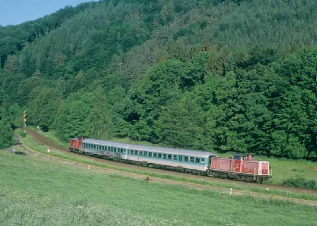
Kurz vor dem Start des neuen Verkehrsvertrages fotografierte Martin Kißler nochmals die alten Züge. 212 275 und eine weitere Lok waren am 15. Mai 2000 mit Regionalbahn 23504 in m Bereich Waldfischbach unterwegs. Das Formsignal zeigte, weithin sichtbar, verlangsamte Einfahrt. Denn der Zug hatte Kreuzung mit einem Gegenzug und musste auf das Ausweichgleis einfahren. Die beiden Nahverkehrswagen zeigten das Farbbild der späten 1980er Jahre (mintgrün).
