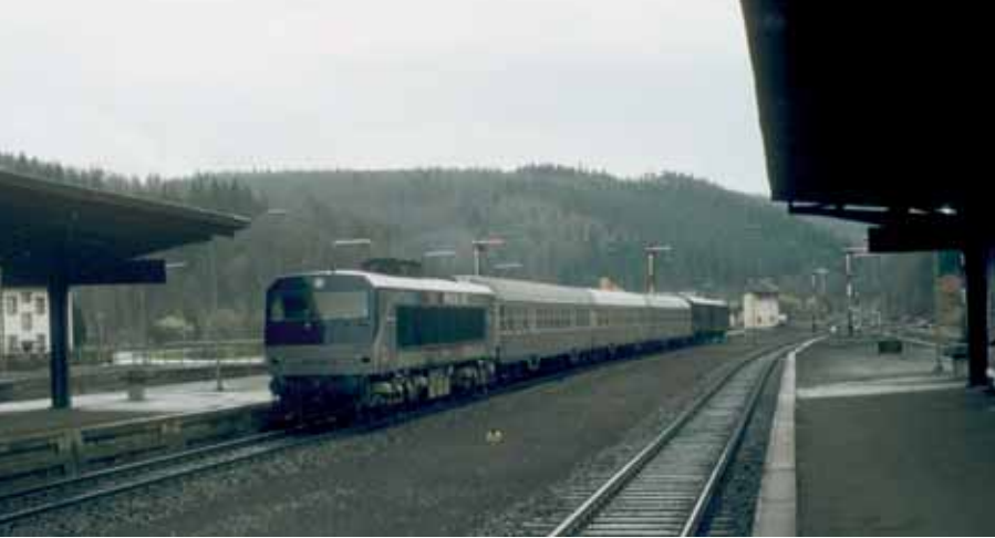
Links oben: Die 'Mutter' vieler modernen Elloks stand zur Versuchszwecken in Diensten der Bundesbahn und befuhr in den Jahren 1984 und 1985 die Strecken rund um Kaiserslautern. 202 003 ist eine diesel-elektrische Lok mit Drehstromantrieb. Der Versuchsträger – außer den drei Testloks gab es keine weiteren – steht heute im Berliner Technikmuseum. Das Foto zeigt die Maschine bei einem der seltenen Einsätze nach Pirmasens mit einem Eilzug im Nordbahnhof.
