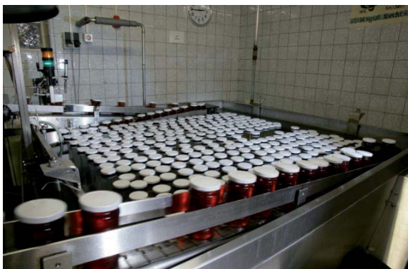
Abb. 26: Wasserbad zur Kühlung der Geleegläser vor dem EffCheck
