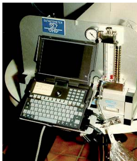
Abb. 18: Geruchsstoffmessung am Olfaktometer
