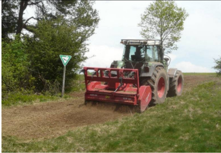
Abb. 1: Forstmulcher bei der Flächenvorbereitung, Wurzelstock- und Gehölzentfernung – RP Kyll, Steinbüchel bei Schüller – Mai 08
