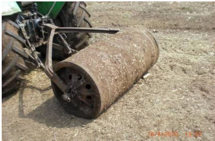
Abb. 5: Einarbeitung des Druschguts und Egalisierung des Oberbodens auf einer Ansaatfläche mit einer Walze – RP Hoch, Schwei- zer Bruch – April 2010
