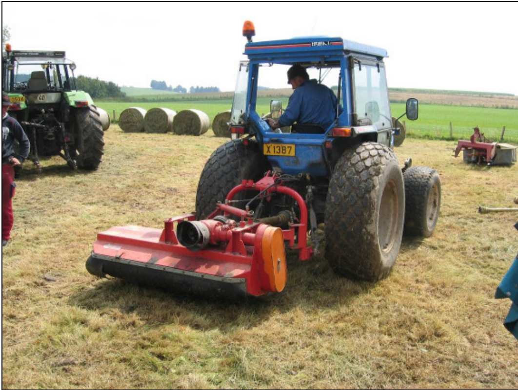
Leichter Traktor mit speziellen, den Bodendruck reduzierenden Reifen und angehängtem Mulchgerät (02.08.2007)
