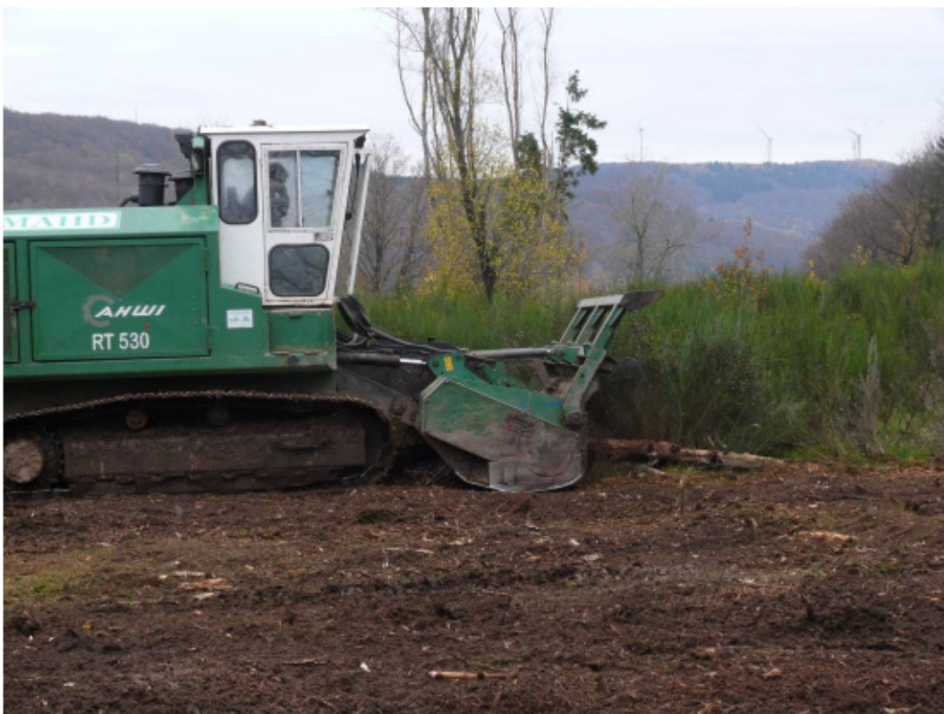
Fräsen der Baumstümpfe mit schwerem Forstmulcher an AHWI-Raupenfahrzeug
