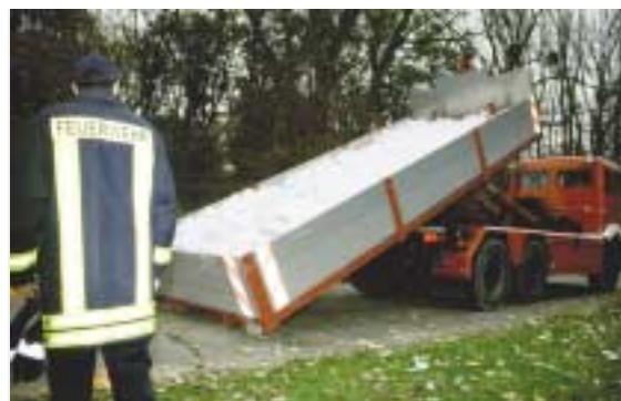
Abrollen einer Wechselpalette. Während der Entladung der Sandsäcke kann das Zugfahrzeug anderweitig eingesetzt werden.
