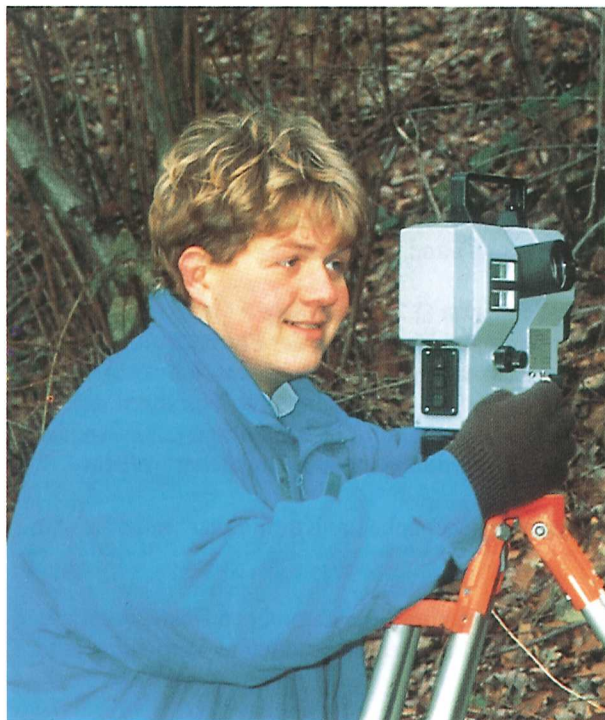
Abb. 38: Um den Grundstückseigentümern die Grenzen der neuen Grundstücke in der Örtlichkeit anzeigen zu können, sowie zur dauerhaften Sicherung mit Grenzmarken, werden Grenzen in die Örtlichkeit übertragen. Dies geschieht mit modernsten Meßmethoden.
