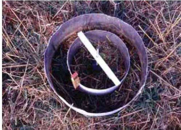
Abb. 5/1: Doppelringinfiltrrometer (IHW, 2000)
